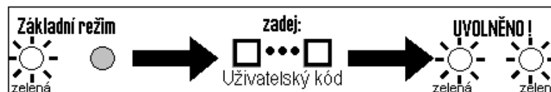
Obrázek 4 - Otevření dveří uživatelským kódem
